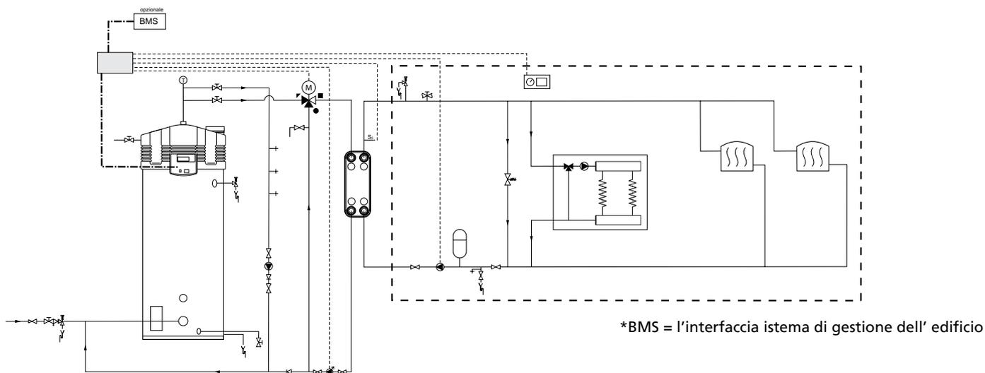
Il Theta Doppio servizio con valvola di miscelazione a tre vie e pompa ACS in combinazione con uno scalda acqua a energia solare SGE
