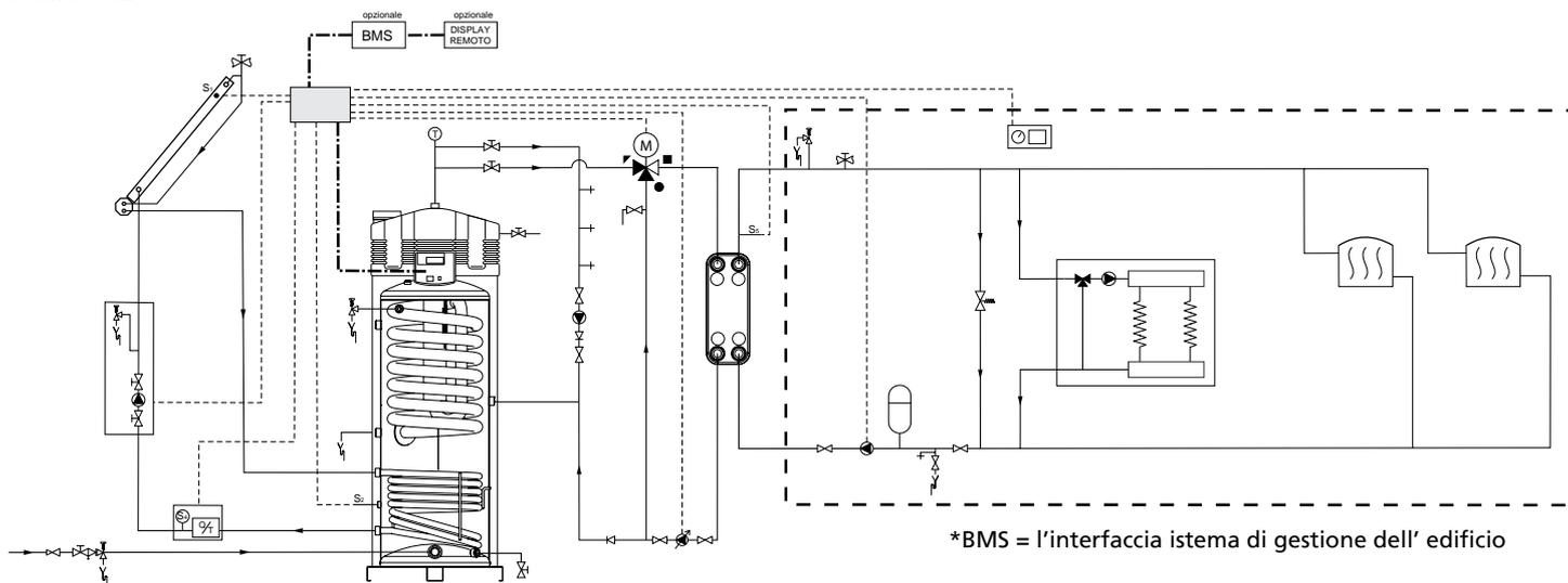
Il Theta Doppio servizio con valvola di miscelazione a tre vie e pompa ACS in combinazione con uno scalda acqua ad energia solare SGS
