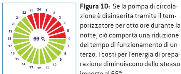
**Figura 10:** Se la pompa di circolazione è disinserita tramite il temporizzatore per otto ore durante la notte, ciò comporta una riduzione del tempo di funzionamento di un terzo. I costi per l'energia di preparazione diminuiscono dello stesso importo al 66%.
